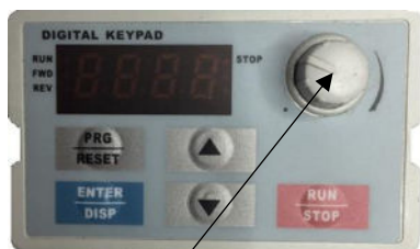
Potenciometer POT na externom paneli
